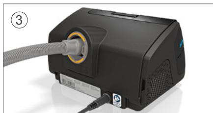
Συνδέστε τη σωλήνωση αέρα σταθερά στην έξοδο αέρα που βρίσκεται στο πίσω μέρος της συσκευής.
